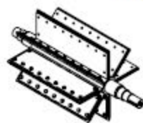
Åpen Rotor med utskiftelige gummi eller vulkollan vingespisser
