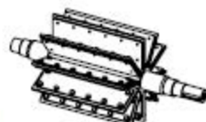
Åpen rotor med utskiftelig gummi eller vulkollan vingespisser
