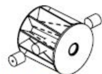
Lukket rotor med faste vinger
