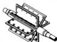
Åpen rotor med utskiftelig gummi eller vulkollan vingespisser
